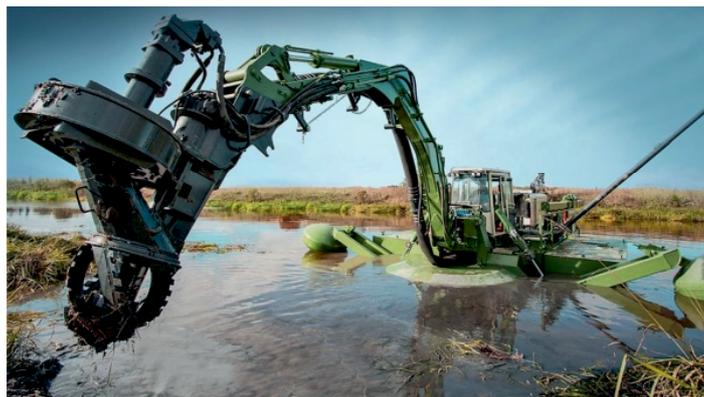
Рисунок 1. Рефулерный земснаряд для очистки водоема
